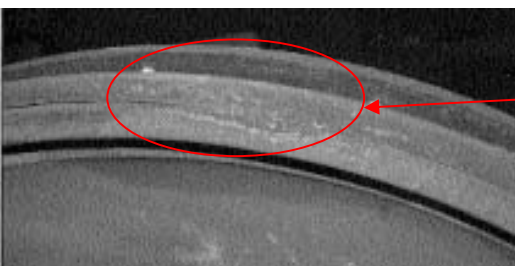
Bild 8 Ungleichmäßige Kontaktfläche über den Umfang des Radkranzes
