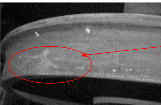
Bild 9 Ungleichmäßig große Auswulzung über den Umfang des Radkranzes
