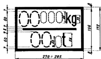
Figure 2 : Tare du wagon et masse freinée du frein à main manœuvrable de la plateforme
