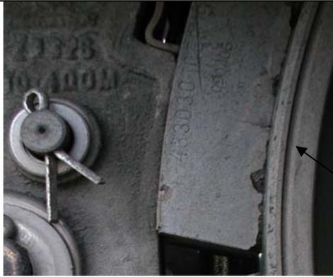
Début de fissure radiale dans le matériau de frottement
