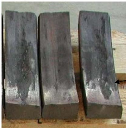
"pellicule blanche" dans la zone de frottement proche de la surface, jusqu'à environ 10 mm de profondeur
