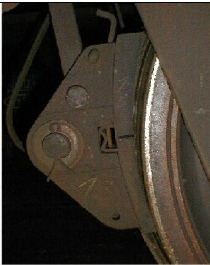
Différence importante dans l'épaisseur de la semelle entre l'extrémité supérieure et inférieure (usure unilatérale).
