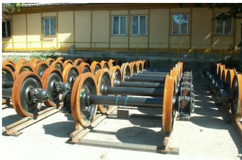
Bild 1: Lagerung im Gleis mittels Sicherungskeilen
