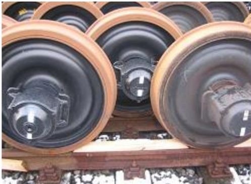
Bild 3: Versetzte Lagerung im Gleis (Doppelschiene)
