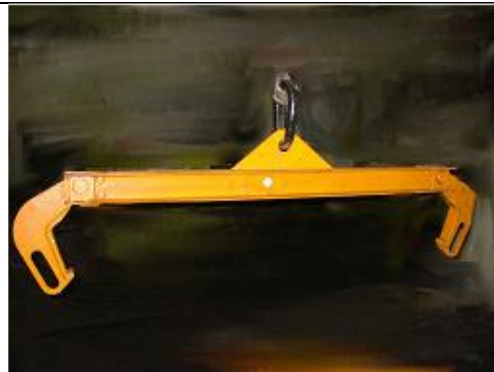
Bild 3: Kranhebestell für Radsätze (Radscheibe)
