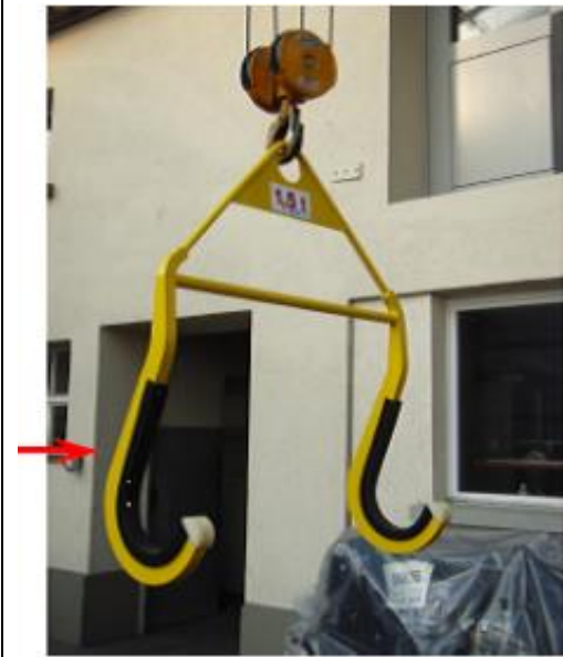
Bild 1: Kranhebestell für Radsätze (Radsatzwelle)
