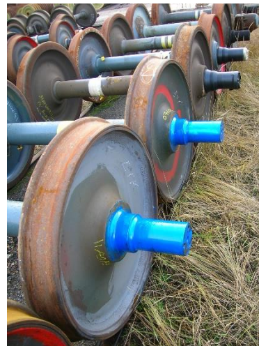
Bild 8: Lagerung von Radsätzen ohne Radsatzlager (Lagersitz mittels Farbanstrich geschützt)
