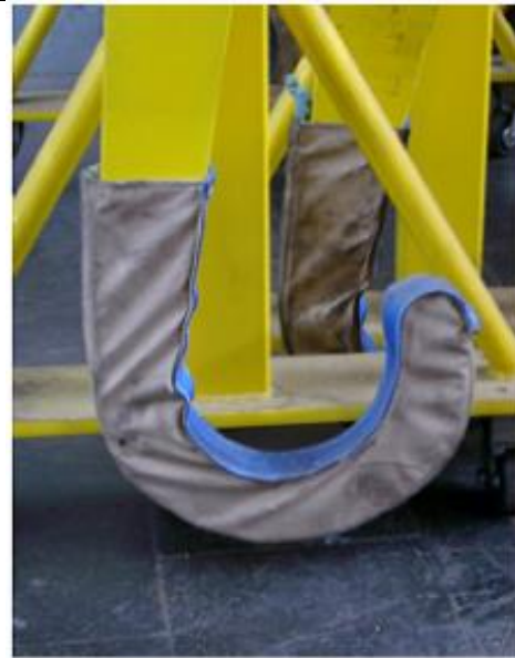
Bild 2: Kranhebestell für Radsätze, Schutz abnehmbar
