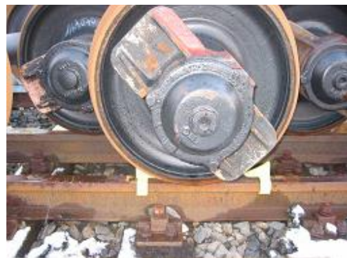
Bild 2: versetzte Lagerung im Gleis mittels Sicherungskeilen
