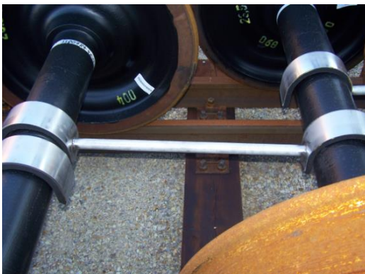
Bild 7: Versetzte Lagerung im Doppelgleis mittels Abstandhaltern
