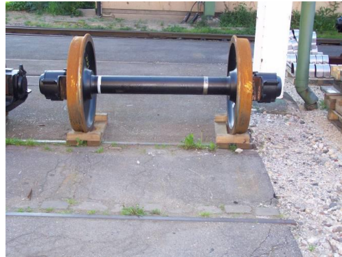
Bild 6: Einzellagerung mittels Ladegestell für Einzelradsätze
