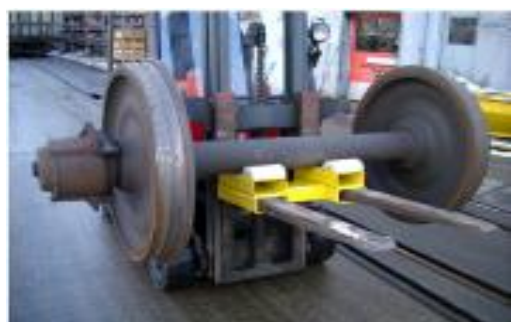
Photo 7 : Support d'essieu pour chariot à fourche (chargé)
