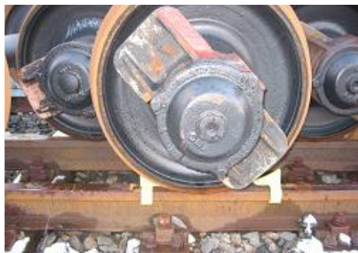
Photo 2 : Stockage en quinconce sur voie à l'aide de cales de sécurité
