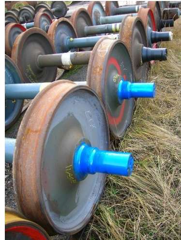
Photo 8 : Stockage d'essieux non boîtés (siège de roulement protégé par de la peinture)
