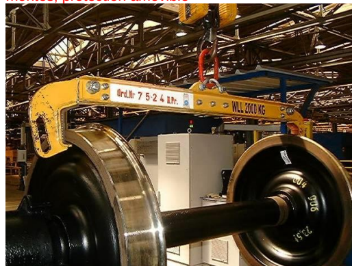
Photo 4 : support d'essieu pour chariot à fourche
