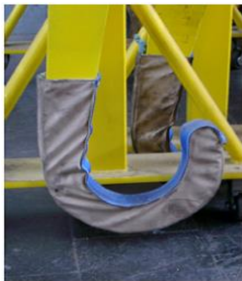
Photo 2 : Châssis de levage de grue pour essieux montés, protection amovible
