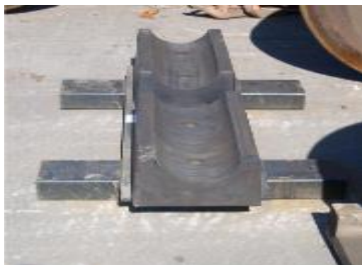
Photo 5 : Support d'essieu chariot à fourche
