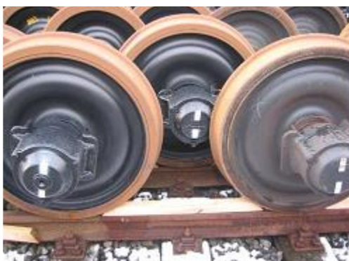
Photo 3 : Stockage en quinconce sur voie (double)
