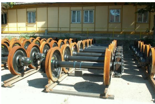
Photo 1 : Stockage sur voie à l'aide de cales de sécurité
