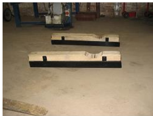
Photo 6 : Support d'essieu pour chariot à fourche
