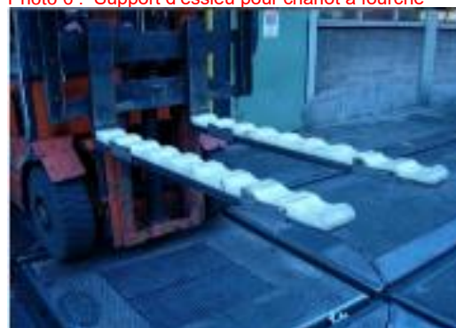
Photo 8 : Support d'essieu pour chariot à fourche (plusieurs essieux)
