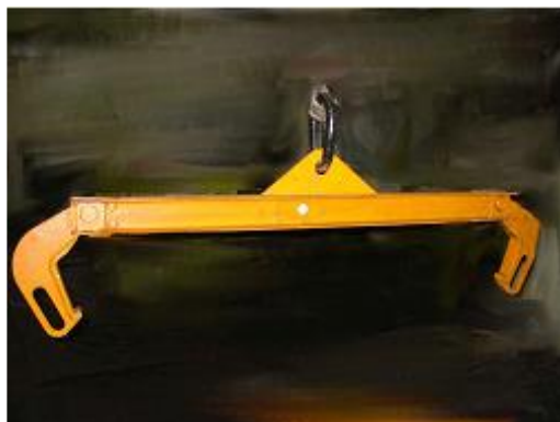
Photo 3 : Châssis de levage de grue pour essieux (disque de roue)
