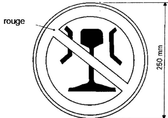
**Positionnement :** A gauche sur chaque longeron, ou sur les éléments recouvrant le longeron ou sur des panneaux spéciaux implantés à la hauteur des longerons.
