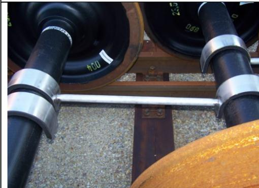
Bild 7: Versetzte Lagerung im Doppelgleis mittels Abstandhaltern
