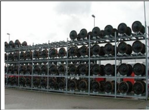
Bild 5: Gestapelte Lagerung mittels Ladegestell
