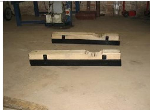
Bild 6: Radsatzaufnahme für Gabelstapler
