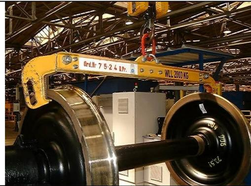
Bild 4: Radsatzaufnahme für Gabelstapler
