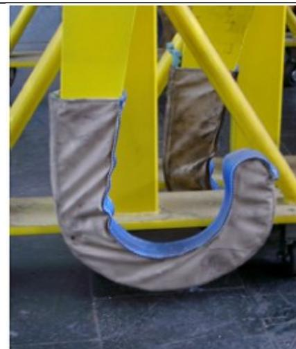
Bild 2: Kranhebestell für Radsätze, Schutz abnehmbar
