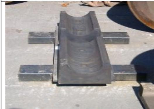
Bild 5: Radsatzaufnahme für Gabelstapler
