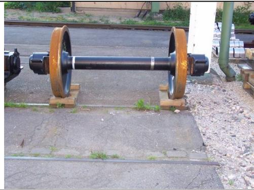
Bild 6: Einzellagerung mittels Ladegestell für Einzelradsätze
