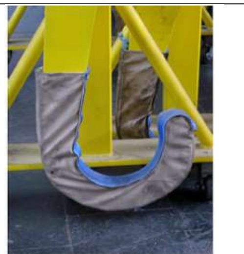
Photo 2 : Châssis de levage de grue pour essieux montés, protection amovible
