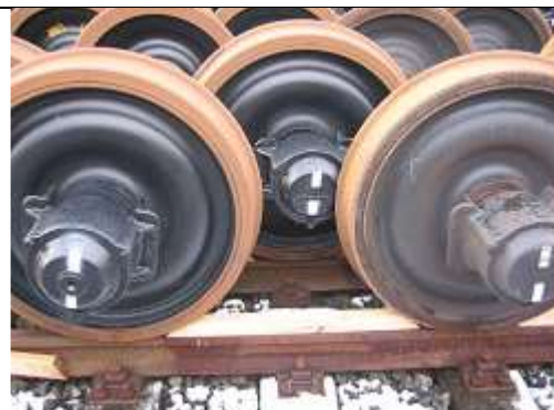
Photo 3 : Stockage en quinconce sur voie (double)
