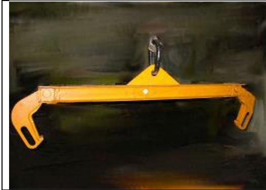
Bild 3: Kranhebegestell für Radsätze (Radscheibe)
