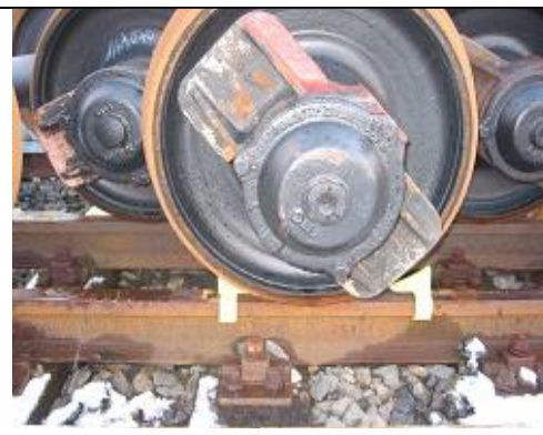
Photo 2 : Stockage en quinconce sur voie à l'aide de cales de sécurité
