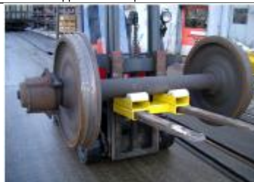
Photo 7 : Support d'essieu pour chariot à fourches (chargé)
