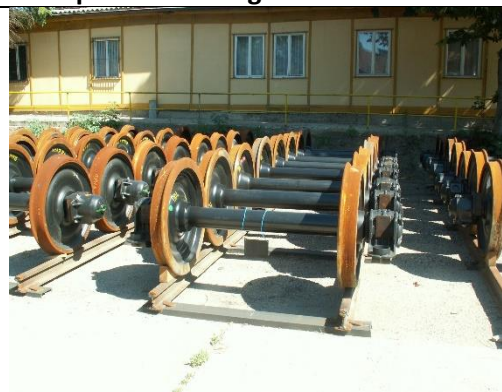
Photo 1 : Stockage sur voie à l'aide de cales de sécurité
