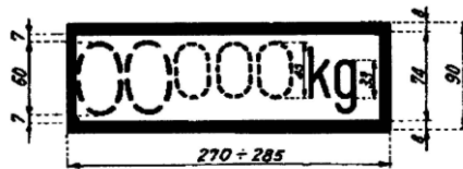
Bild 2: Eigengewicht des Wagens und Bremsgewicht der von der Plattform aus bedienbaren Handbremse
