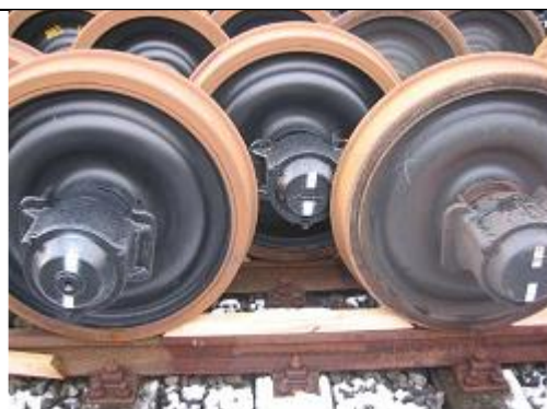
Photo 3 : Stockage en quinconce sur voie (double)
