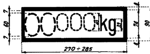
Figure 2 : Tare du wagon et masse freinée du frein à main manœuvrable de la plate-forme
