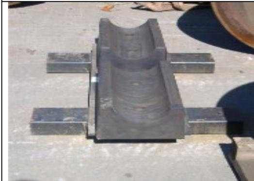
Bild 5: Radsatzaufnahme für Gabelstapler
