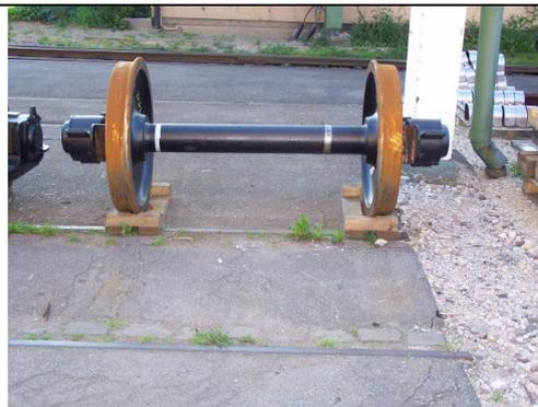
Bild 6: Einzellagerung mittels Ladegestell für Einzelradsätze
