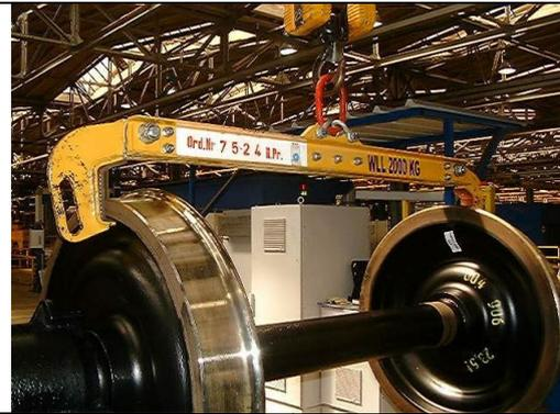
Bild 4: Radsatzaufnahme für Gabelstapler
