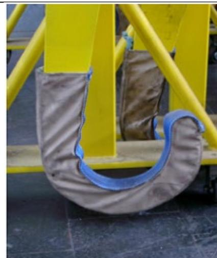
Bild 2: Kranhebestell für Radsätze, Schutz abnehmbar
