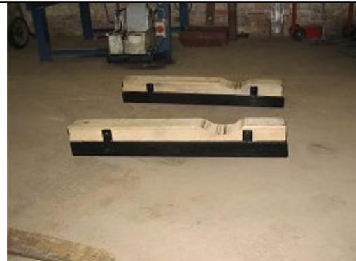
Bild 6: Radsatzaufnahme für Gabelstapler
