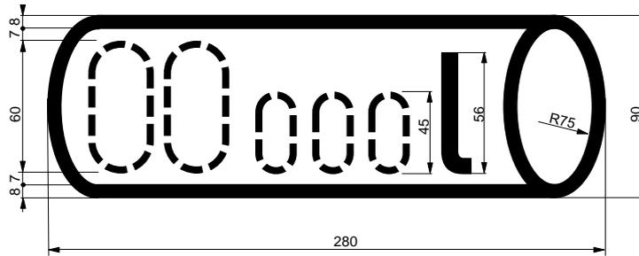
**Anordnung:** Auf jeder Seitenwand links, bei Kesselwagen auf dem Tank selbst oder auf den Anchriftentafeln.
