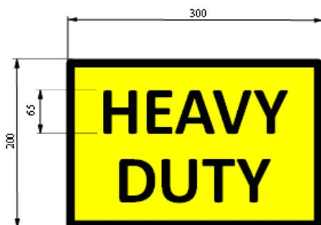
Auf Tragwagen **mit verstärkten Rückhaltevorrichtungen** ist dieses Piktogramm in der Nähe des Wagenbestimmungs-codes am Langträger anzubringen.
