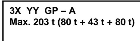
**Bedeutung:** Beispiel einer Kennzeichnung für ständig gekuppelte Wageneinheiten mit 3 Steuerventilen (3X), Kurzbezeichnung der Bremsbauart nach Ziffer 4.3.9 (YY), Zusatzbezeichnungen nach Ziffer 4.3.9 (GP, A).
