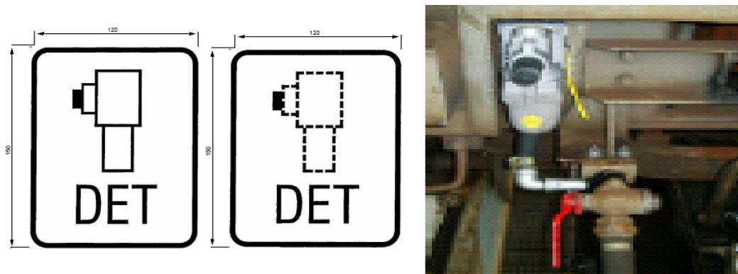
**Anordnung:** Für Güterwagen an beiden Wagenseiten wenn der Entgleisungsdetektor einsehbar ist. Das Zeichen für Entgleisungsdetektoren ist strichliert dargestellt, wenn der Entgleisungsdetektor nicht einsehbar ist.
