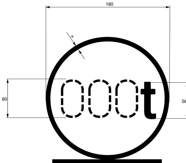
**Anordnung:** An jedem Langträger rechts oder an den die Langträger überdeckenden Bauteilen oder an besonderen Tafeln in Höhe der Langträger.
