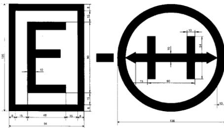
**Anordnung:** Auf jeder Seitenwand rechts (an den Wagen). Das rechte Zeichen alleine befindet sich auch an den entsprechenden Drehgestellrahmen.
