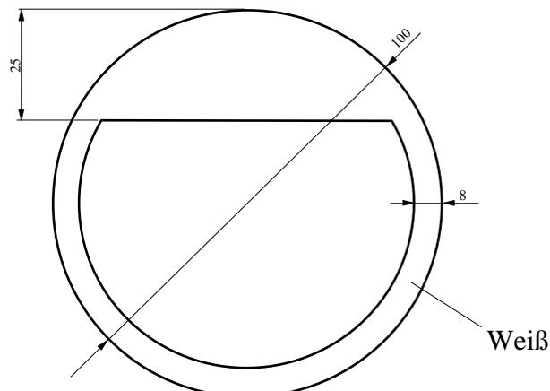
**Anordnung:** An jedem Langträger in der Mitte oder an den die Langträger überdeckenden Bauteilen oder an besonderen Tafeln in Höhe der Langträger. Dieses Zeichen kann auch auf jeder Seitenwand rechts angebracht sein.
