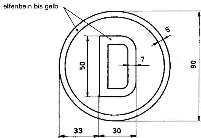
**Anordnung:** Auf beiden Wagenseiten unmittelbar rechts neben der Anschrift zur Bremsbauart.
