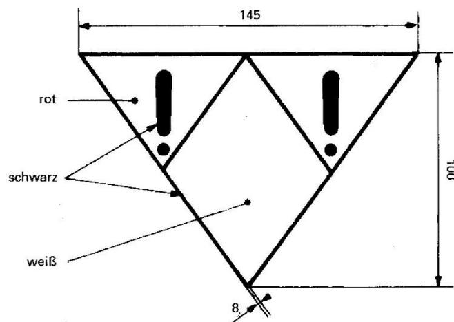
**Anordnung:** An jedem Langträger links oder an den überdeckenden Bauteilen oder an besonderen Tafeln in Höhe der Langträger.
