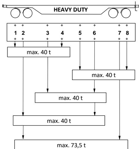
Das Beladeschema ist an Wagen mit verstärkten Rückhaltevorrichtungen anzubringen.
