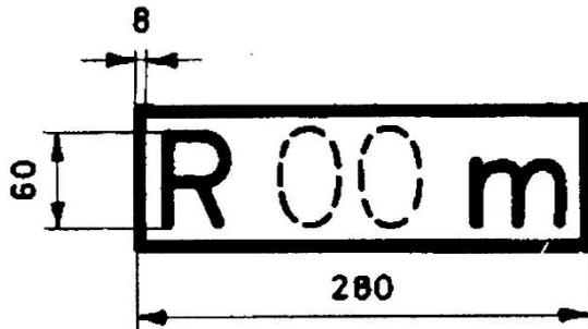
**Anordnung:** An jedem Langträger links oder an den die Langträger überdeckenden Bauteilen oder an besonderen Tafeln in Höhe der Langträger.
