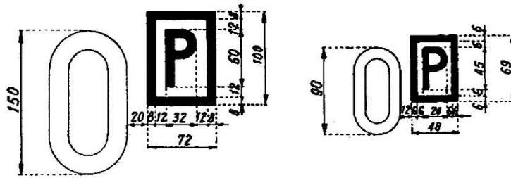
**Anordnung:** Hinter der Selbstkontrollziffer der Wagennummer, auf jeder Seitenwand links.
