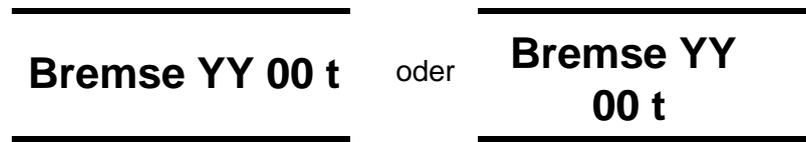
**Anordnung:** An jedem Langträger in der Nähe der Anschrift der Bremsbauart.
