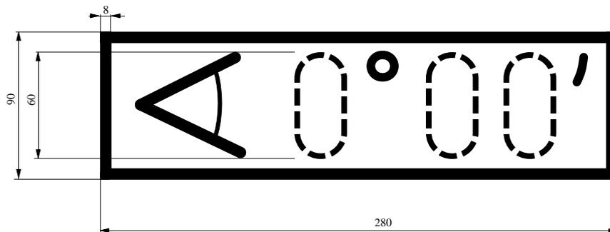
**Anordnung:** An jedem Langträger links oder an den überdeckenden Bauteilen oder an besonderen Tafeln in Höhe der Langträger.
