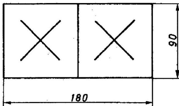
**Anordnung:** An jedem Langträger rechts oder an den die Langträger überdeckenden Bauteilen oder an besonderen Tafeln in Höhe der Langträger.
