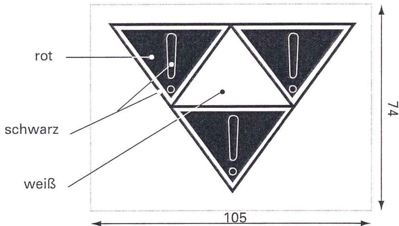
**Anordnung:** An jedem Langträger links oder an den überdeckenden Bauteilen oder an besonderen Tafeln in Höhe der Langträger.
