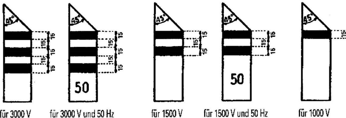
**Anordnung:** An den Stirn- und Längsseiten der Ecksäulen, unten. Es wird empfohlen, auf den Wagen, die keine Ecksäulen haben, die vorgeschriebenen Kennzeichen auf ein Blech anzubringen.
