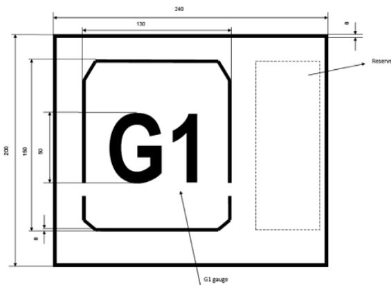
Kennzeichnung von Wagen, die nach der Begrenzungslinie „G 1“ gebaut und für den interoperablen Verkehr zugelassen sind.
