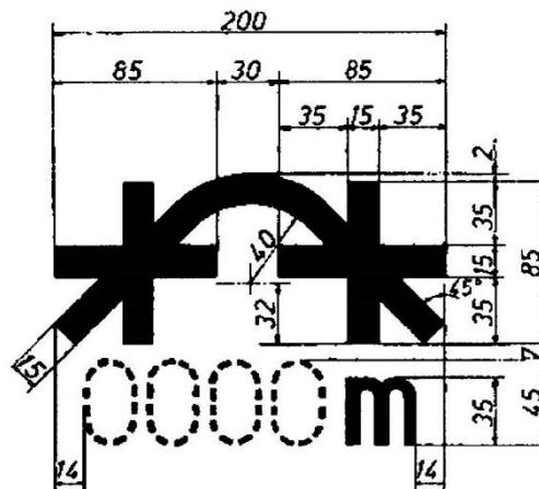
**Anordnung:** An jedem Langträger links oder an den die Langträger überdeckenden Bauteilen oder an besonderen Tafeln in Höhe der Langträger.
