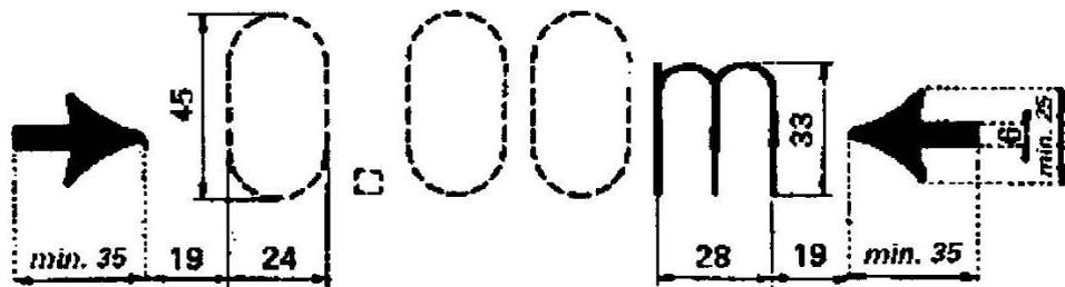
**Anordnung:** An jedem Langträger rechts bzw. an den Langträgern der Drehgestelle (es genügt, wenn das Zeichen auf der Wange des linken Drehgestells jeder Wagenseite angebracht wird) oder an den die Langträger überdeckenden Bauteilen oder an besonderen Tafeln in Höhe der Langträger.
