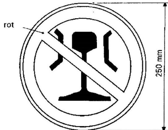
**Anordnung:** An jedem Langträger links oder an den die Langträger überdeckenden Bauteilen oder an besonderen Tafeln in Höhe der Langträger.
