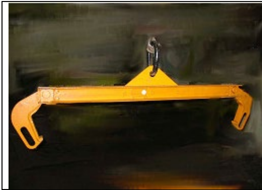
Bild 3: Kranhebestell für Radsätze (Radscheibe)
