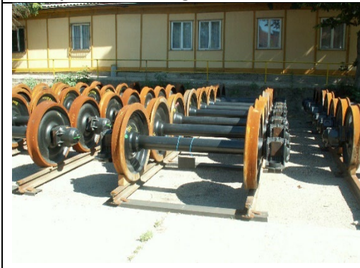
Photo 1 : Stockage sur voie à l'aide de cales de sécurité
