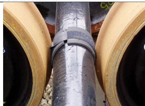
Photo 4 : Stockage en quinconce sur voie avec protection de contact
