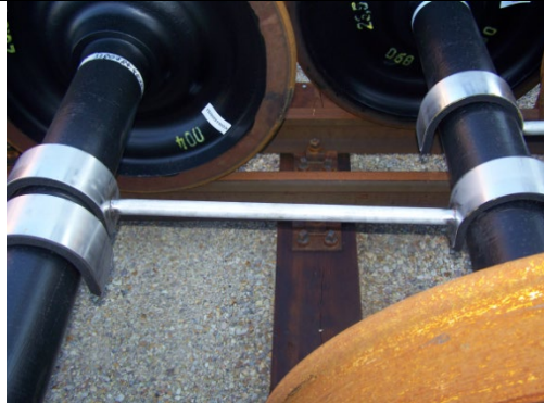
Photo 7 : Stockage en quinconce sur voie double à l'aide d'entretoises
