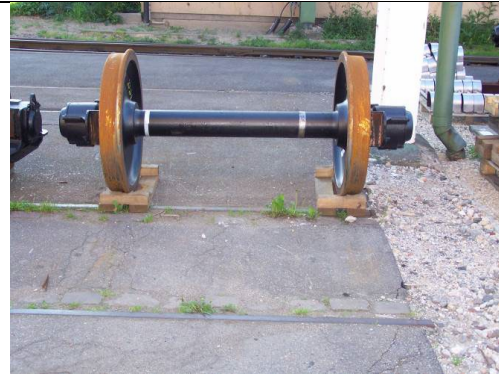
Photo 6 : Stockage individuel à l'aide de casiers de stockage pour essieux simples
