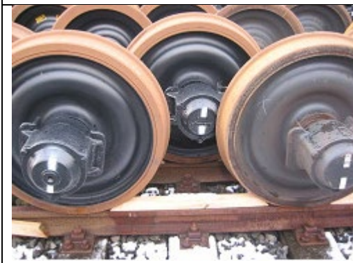
Photo 3 : Stockage en quinconce sur voie (double)
