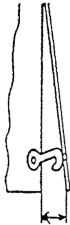
Schrägstellung der Tür gegenüber Seitenwand
