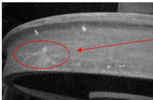
Fig. 9 Ecrasement important et irrégulier sur le pourtour de la jante-bandage
