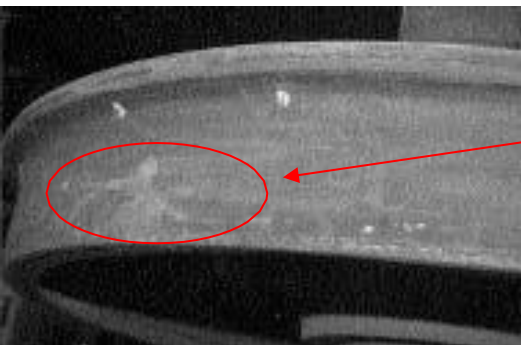
Bild 9: Ungleichmäßig und große Auswulzung über den Umfang des Radkranzes
