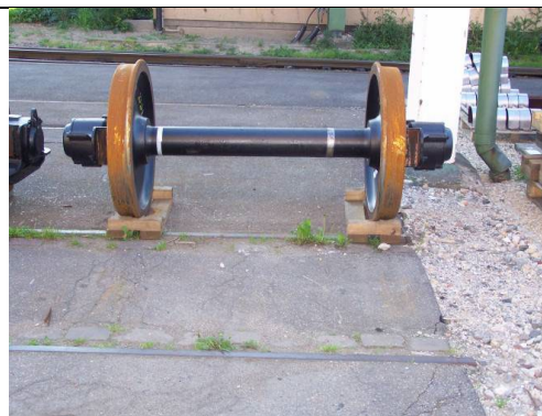
Photo 6 : Stockage individuel à l'aide de casiers de stockage pour essieux simples
