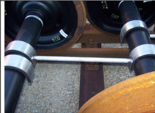
Bild 7: Versetzte Lagerung im Doppelgleis mittels Abstandhalter
