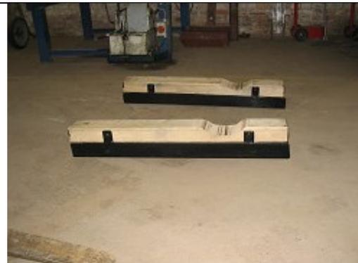
Bild 6: Radsatzaufnahme für Gabelstapler
