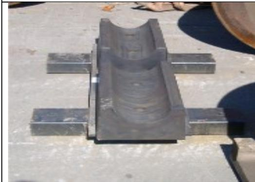
Bild 5: Radsatzaufnahme für Gabelstapler
