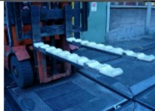
Bild 8: Radsatzaufnahme für Gabelstapler (mehrere Radsätze)
