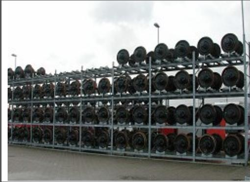
Bild 5: Gestapelte Lagerung mittels Ladegestell
