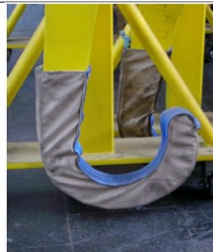
Bild 2: Kranhebestell für Radsätze, Schutz abnehmbar
