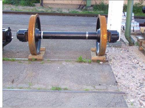
Bild 6: Einzellagerung mittels Ladegestell für Einzelradsätze
