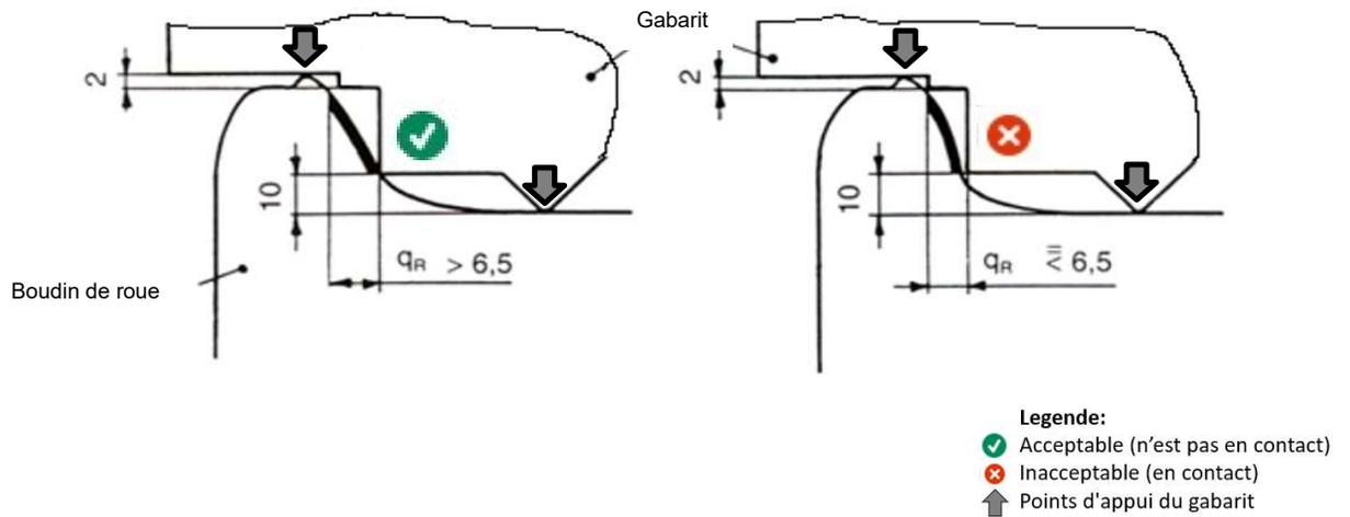
Figure 5 : Hauteur du boudin de roue (Mesure Sh)
