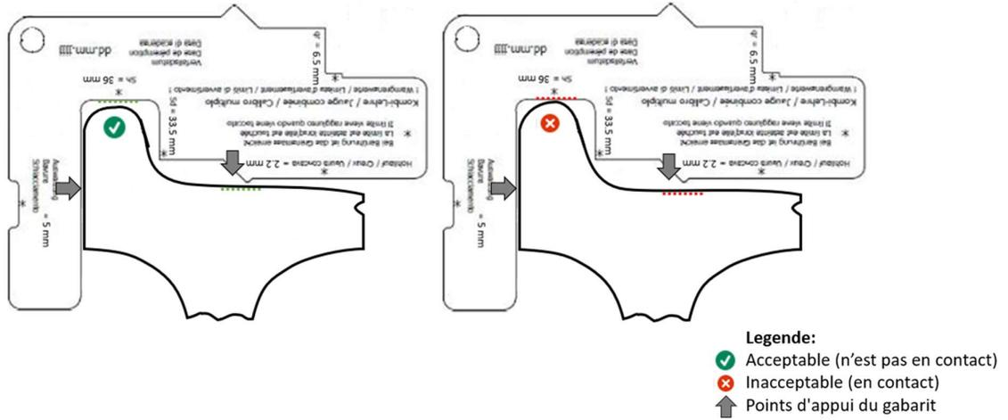
Figure 6 : Largeur du boudin de roue (Mesure Sd)
