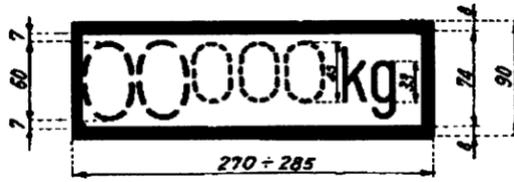
Figure 2 : Tare du wagon et masse freinée du frein à main manœuvrable de la plate-forme
