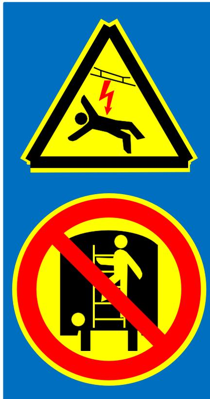
**Positionnement :** Sur les wagons munis de marchepieds ou d'échelles, à proximité immédiate de ceux-ci, et à la hauteur des yeux. A utiliser sur les wagons pour lesquels le marchepied supérieur ou la partie la plus élevée de l'échelle se trouve à plus de 2 m au-dessus du niveau du rail ou sur les wagons dont la structure permet de monter sur celui-ci.
