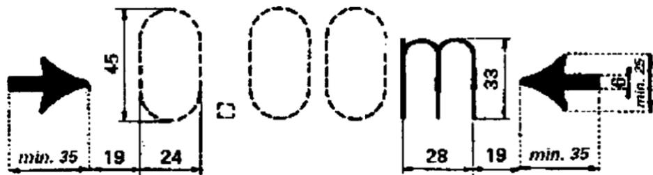
**Positionnement :** A droite sur chaque longeron, ou sur les châssis de bogies (il suffit que le signe figure sur le châssis du bogie gauche de chaque côté du wagon) ou sur les éléments recouvrant le longeron ou sur des panneaux spéciaux implantés à la hauteur des longerons.
