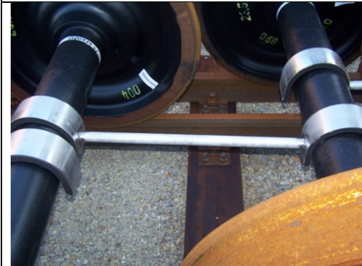
Bild 7: Versetzte Lagerung im Doppelgleis mittels Abstandhalter
