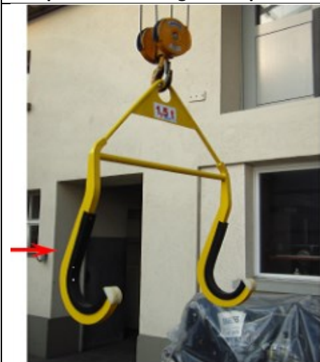
Bild 1: Kranhebestell für Radsätze (Radsatzwelle)
