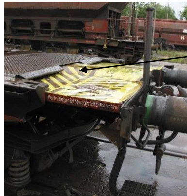
Surfaces zébrées jaunes et noires d'accès interdit
