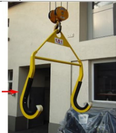
Photo 1 : Châssis de levage de grue pour essieux montés (essieu-axe)
