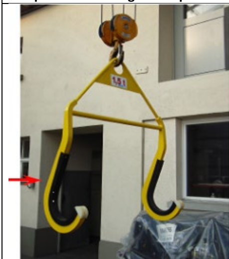
Bild 1: Kranhebegestell für Radsätze (Radsatzwelle)
