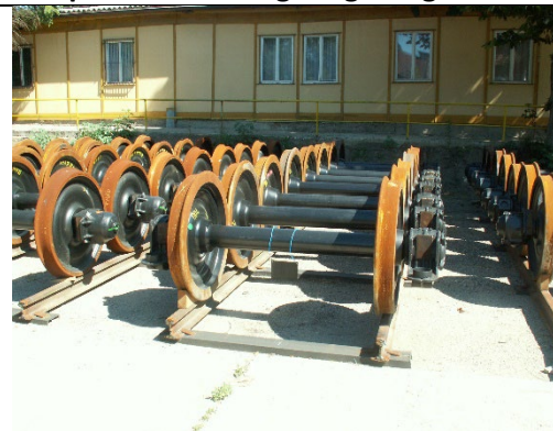
Bild 1: Lagerung im Gleis mittels Sicherungskeilen
