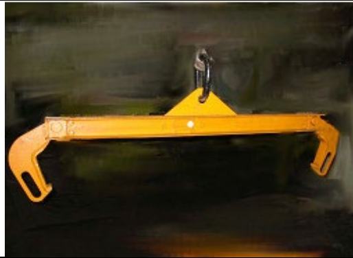
Bild 3: Kranhebegestell für Radsätze (Radscheibe)
