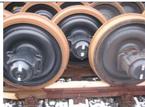
Bild 3: Versetzte Lagerung im Gleis (Doppelschiene)
