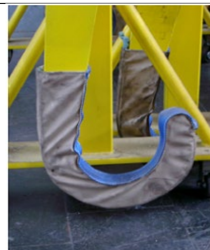
Bild 2: Kranhebegestell für Radsätze, Schutz abnehmbar
