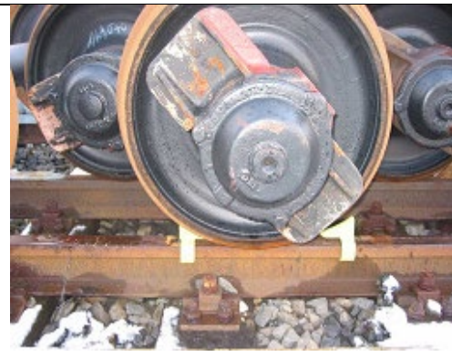
Bild 2: versetzte Lagerung im Gleis mittels Sicherungskeilen
