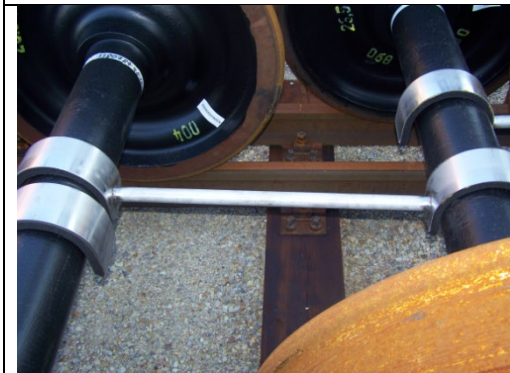
Bild 7: Versetzte Lagerung im Doppelgleis mittels Abstandhalter
