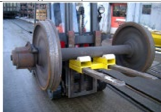
Photo 7 : Support d'essieu pour chariot à fourches (chargé)
