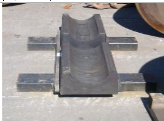
Photo 5 : Support d'essieu pour chariot à fourches
