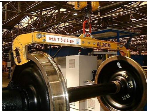
Photo 4 : support d'essieu pour chariot à fourches
