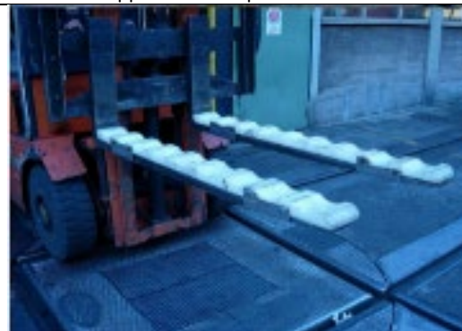
Photo 8 : Support d'essieu pour chariot à fourches (plusieurs essieux)
