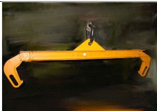
Photo 3 : Châssis de levage de grue pour essieux (disque de roue)
