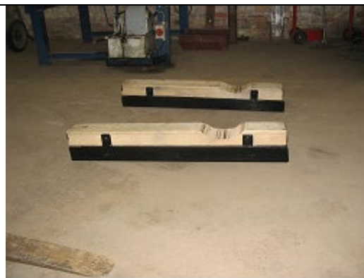
Photo 6 : Support d'essieu pour chariot à fourches
