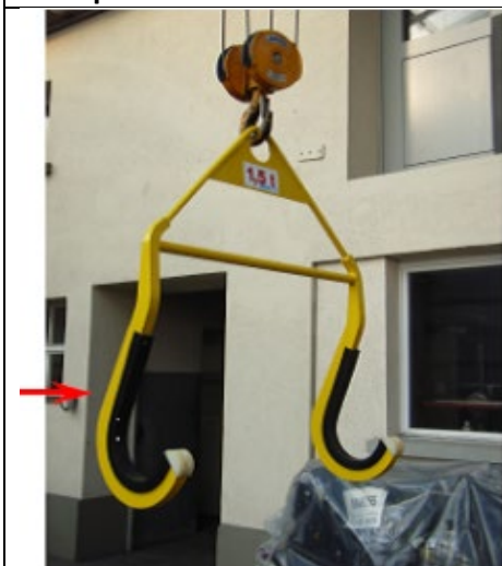
Photo 1 : Châssis de levage de grue pour essieux montés (essieu-axe)
