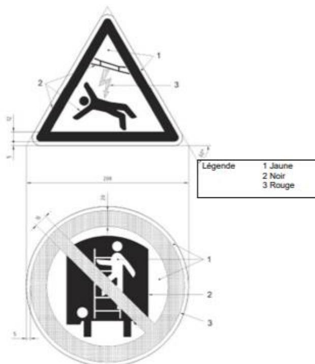
**Positionnement :** Sur les wagons munis de marchepieds ou d'échelles, à proximité immédiate de ceux-ci, et à la hauteur des yeux. A utiliser sur les wagons pour lesquels le marchepied supérieur ou la partie la plus élevée de l'échelle se trouve à plus de 2 m au-dessus du niveau du rail ou sur les wagons dont la structure permet de monter sur celui-ci.
